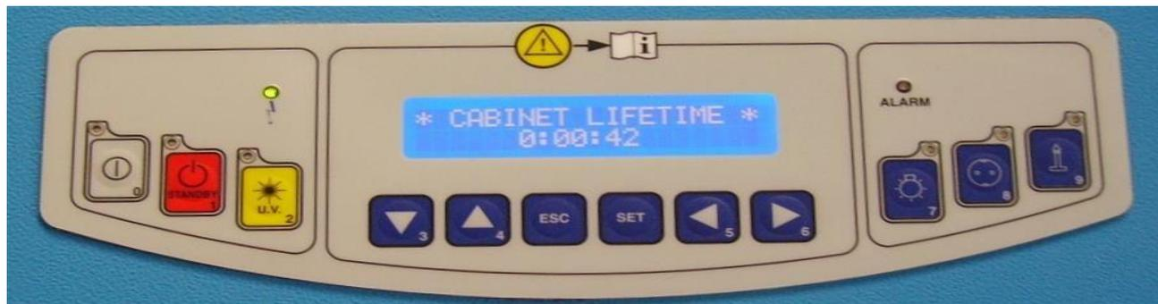
Il contatore inizia il conteggio quando viene avviata la ventilazione e si ferma allo spegnimento della cappa.
