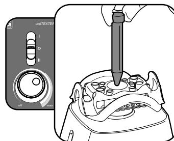
**Hinweis:** Um eine Überhitzung des Vortexers im Dauerbetrieb zu verhindern, gibt es eine interne Temperaturschutzvorrichtung, die das Gerät vorübergehend abschaltet. Sobald das Gerät abgekühlt ist, ist es wieder betriebsbereit. Bitte stellen Sie den Schalter in die Position **OFF**, wenn das Gerät nicht im Betrieb ist.
