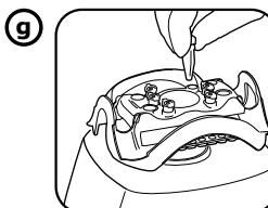
**H. Chargement des tubes de 2 mL (languette de 2 tubes – 24 maximum)**
