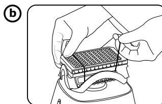
Sécurisez le plateau d'essai avec l'élastique de maintien fourni
