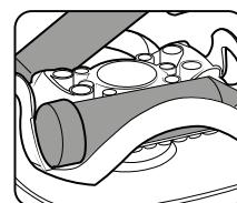
Bouchon du tube de 50 mL bien fixés sur la partie creuse de la tête
