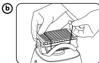
Asegure la bandeja de ensayo con el cordón elástico suministrado acoplado al cabezal de mezcla
