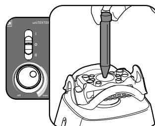
**Remarque :** Pour éviter la surchauffe de l'Agitateur à vortex pendant une utilisation continue, l'unité est munie d'un dispositif de protection thermique interne, qui arrêtera temporairement le dispositif. Une fois le dispositif refroidi, il se remettra en marche automatiquement.
