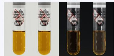
2 cuvette (A | B) con la stessa concentrazione di COD. La torbidità nella cuvetta B influenza il risultato fino al 30%.
