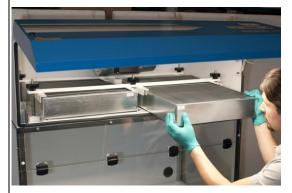
I filtri sono alloggiati in modo da permettere una sostituzione facile anche da parte del cliente.
