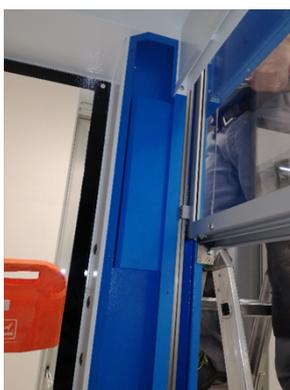
Guide in alluminio lineari Drylin sui quali si muovono dei cuscinetti in teflon ad alto scorrimento resistenti alle sostanze chimiche, assicurano un movimento lineare, confortevole ed agevole del vetro stesso.
