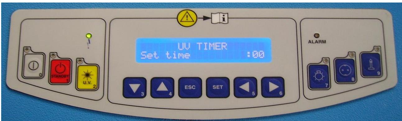
Ora con le frecce è possibile impostare il tempo di accensione della lampada UV; quando viene premuto SET parte il conto alla rovescia e quando viene raggiunto "0:00" la lampada UV si spegne. (se in fase di impostazione del tempo di accensione si imposta "0:00" la lampada UV rimane accesa fino alla successiva pressione del pulsante UV)
