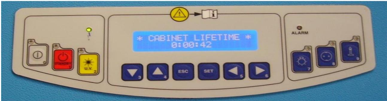
Il contaore inizia il conteggio quando viene avviata la ventilazione e si ferma allo spegnimento della cappa. E' possibile azzerare il contaore premendo in sequenza i seguenti tasti:
